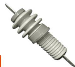
Изоляторы проходные ИПУ-10 предназначены для проведения и изоляции токоведущих частей закрытых распределительных устройств электрических станций и подстанций, комплектных распределительных устройств, соединения с открытыми распределительными устройствами или линиями электропередачи на переменное напряжение свыше 1000 В, частотой 100 Гц, а также для закрытых токопроводов.
